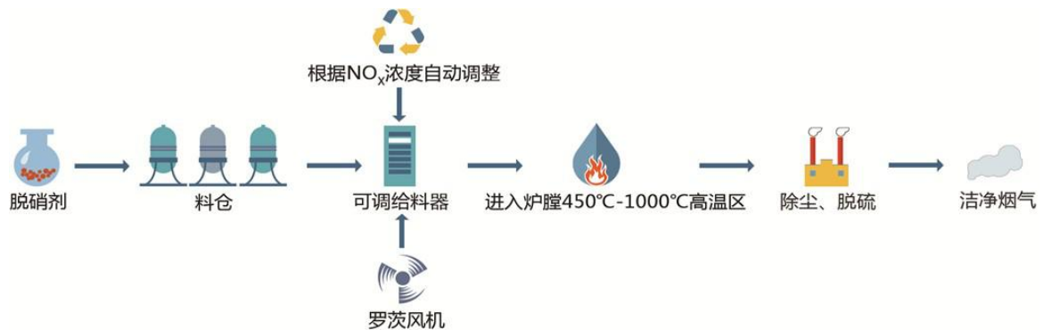
图 3.5 PNCR 法脱硝工艺示意图
