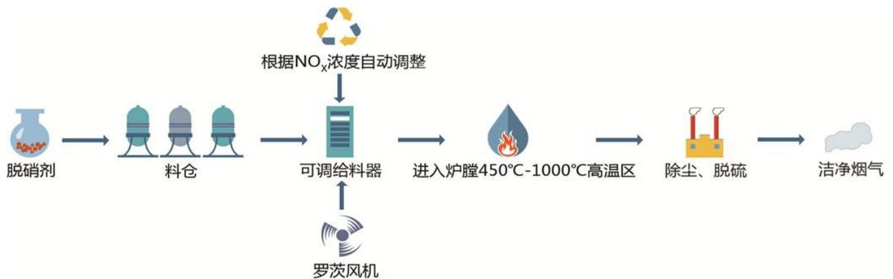
图 2.4 PNCR 法脱硝工艺流程
